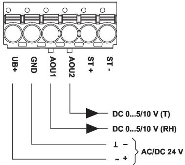
ST+/ST bağlantı elemanları yalnızca sıcaklık ölçümü için ilaveten pasif bir direnç sensörü elemanına sahip sensör türleri için kullanılır.
